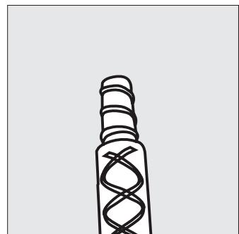
1. Las boquillas proporcionadas permiten un patrón de rociado en abanico.
