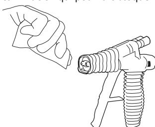
Changez fréquemment les buses! La mousse durcira à l'intérieur de la buse dans le même laps de temps que la mousse devient non collante dans l'air.
