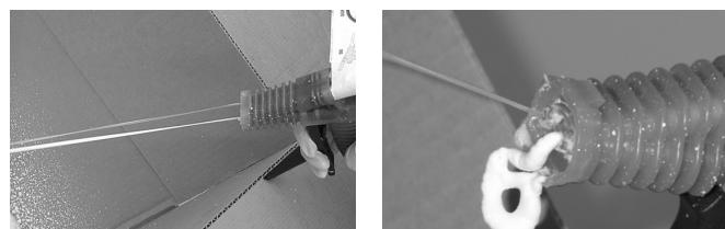
Une fois la buse retirée, vérifiez que les deux produits chimiques s'écoulent avec une force équivalente.
