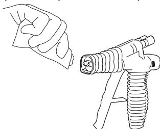
¡Cambio las boquillas con frecuencia! La espuma se curará dentro de la boquilla en la misma cantidad de tiempo que la espuma se vuelve pegajosa en el aire.
