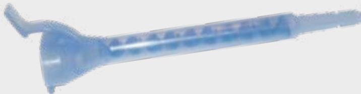
**Les embouts d'avertissement de température ColorWise®** passent du clair au bleu, indiquant que le produit chimique a atteint des températures froides inférieures à 60°F (16°C) et que la mousse ne doit pas être distribuée. Arrêtez la pulvérisation pour éviter une mousse non proportionnelle et une perte de rendement, et conditionnez correctement le produit chimique avant de le pulvérer à nouveau.
