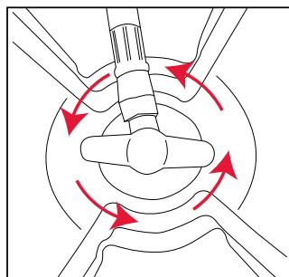
3. Ouvrir les vannes complètement en tournant les vannes DANS LE SENS CONTRAIRE DES AIGUILLES D'UNE MONTRE. Les vannes des cylindres doivent être debout pendant l'utilisation.
