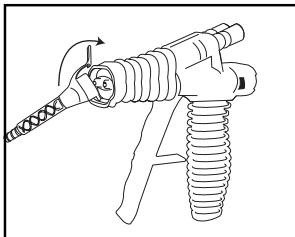
2. Insérez la languette du gicleur dans la fente sur la partie inférieure de l'unité de dispersion.
