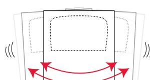
2. Agiter le kit pendant 1 à 2 minutes avant l'utilisation pour assurer un bon mélange, voir la FT pour les recommandations de mélange spécifiques à la formule. Le produit chimique doit normalement être à une température de 70 à 85° F (21 à 29° C).
