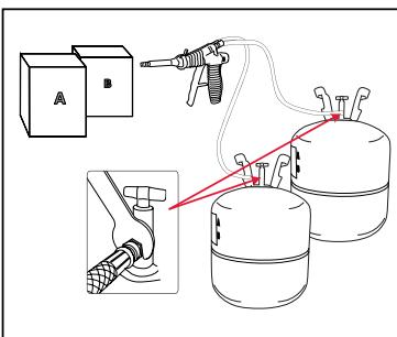
2. Visser le tuyau codé en rouge codé au cylindres de composant A et le tuyau codé noir au cylindres de composant B et serrer avec la clé de 9/16 de pouce fournie.
