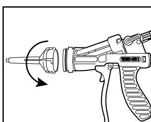
2. Conecte la boquilla mediante un giro a la derecha a la posición de bloqueo.
