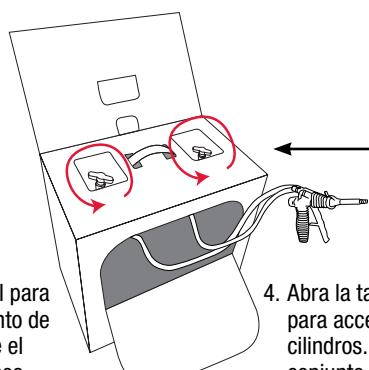
3. Presione la parte superior del panel frontal para abrir. Baje la solapa para obtener el conjunto de manguera de la unidad dosificadora. Quite el paquete de la boquilla y lea las instrucciones.
