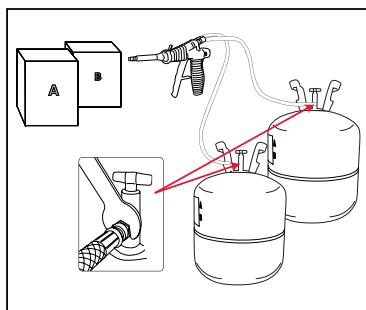
2. Conecte la manguera de código rojo al cilindros del componente "A" y la manguera de código negro al cilindros del componente "B", y apriete con una llave inglesa de 9/16".
