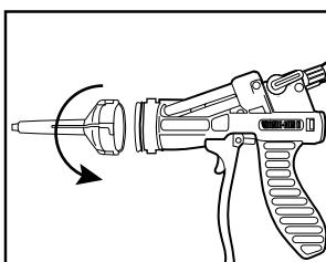
2. Fixez la buse en tournant vers la droite dans la position de verrouillage.
