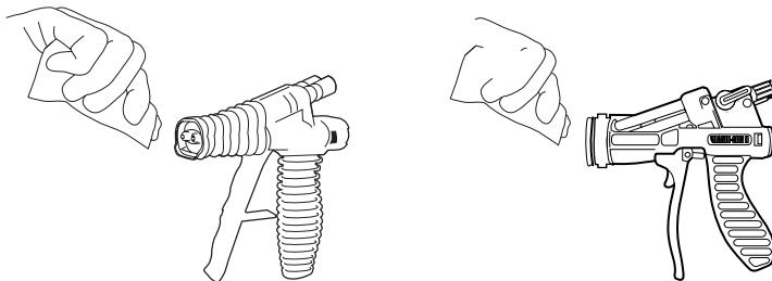
¡Cambio las boquillas con frecuencia! La espuma curará dentro de la boquilla en el mismo lapso de tiempo en que la espuma deja de ser pegajosa al aire.
