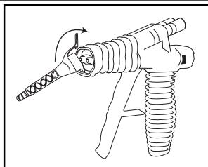
2. Inserte la lengüeta inferior de la boquilla en la ranura inferior de la unidad dosificadora.
