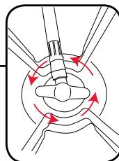
5. Ouvrir les vannes complètement en tournant les vannes DANS LE SENS CONTRAIRE DES AIGUILLES D'UNE MONTRE. Le rabat supérieur peut être enlevé ou laissé en place pendant l'utilisation ou le stockage.
