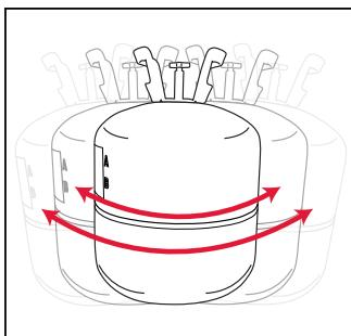
1. Agite el envase durante 1 ó 2 minutos antes del uso para asegurar que se mezcle adecuadamente; consulte la hoja de datos técnicos en cuanto a las recomendaciones específicas para la fórmula. Típicamente, la temperatura de la sustancia química debe estar entre 21 y 29°C (70 y 85°F).
