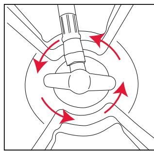
3. Abra las válvulas completamente girándolas a la IZQUIERDA. La tapa superior se puede quitar o simplemente dejar en su lugar durante el uso o almacenaje del material. Las válvulas del cilindros deben estar en posición vertical durante su uso.
