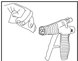
1. Avant de fixer la buse, appliquer de la vaseline sur l'embout du pistolet.
